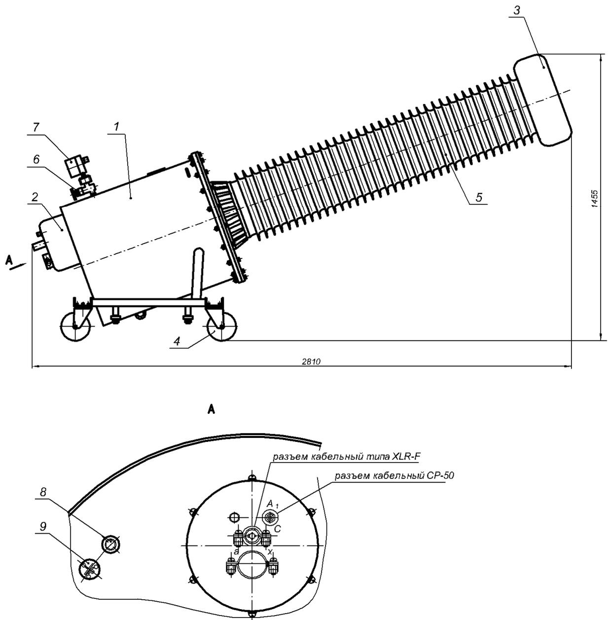
1 – корпус; 2 – крышка; 3 – экран; 4 – колесо; 5 – изолятор; 6 – клапан сильфонный;
