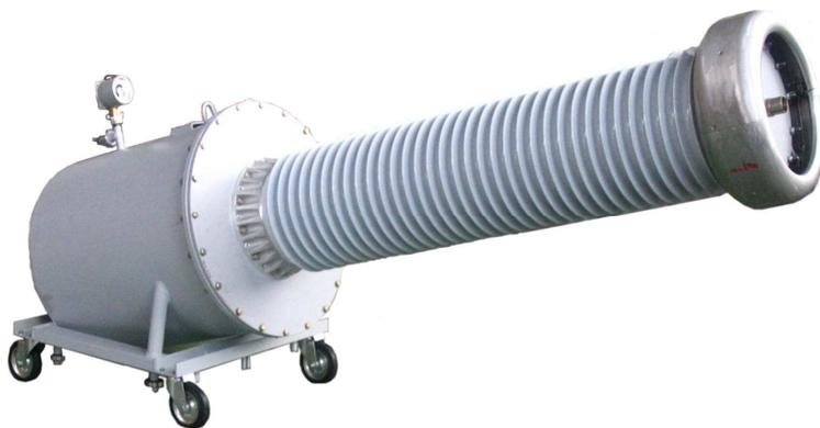
Испытательный трансформатор ИОГ-250 предназначен для применения в составе передвижной испытательной лаборатории для испытания высоковольтного электротехнического оборудования (трансформаторы тока и напряжения, силовые трансформаторы, разъединители, вводы и т.п.) кратковременным напряжением частоты 50 Гц, включая испытания с измерением емкости изоляции ( $C_X$ ), тангенса угла диэлектрических потерь ( $\operatorname{tg} \delta_{и}$ ) и частичных разрядов (ЧР).
