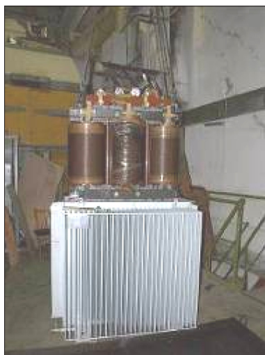
Трансформатор после испытаний на стойкость к токам короткого замыкания
