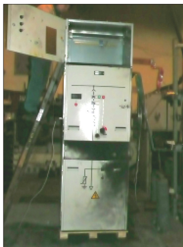
КРУ после испытаний на локализационную способность
